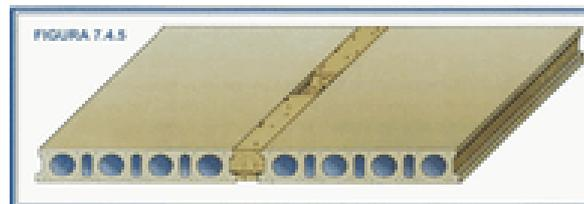
La solución más adecuada es aquella en la cual el diámetro del taladro coincide con la anchura de un alveolo. En este caso una disposición adecuada de la armadura activa evita que se vea afectada al realizarse el taladro. Con esta solución los taladros pueden realizarse en obra y, en general, sus efectos sobre la ALVEOPLACA son admisibles.
